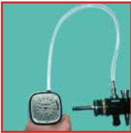
Manueller Dichtheitstest bei einem flexiblen Endoskop
