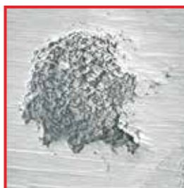
Korrosionsloch – betrachtet unter Rasterelektronenmikroskop – 200-fache Vergrößerung
