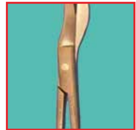
Beizangriff der Instrumentenoberfläche. Ursache: Säureangriff wegen Überdosierung.
