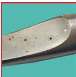
Chloridinduzierte Lochkorrosion auf dem Instrument.
