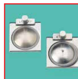
Rechts: Undichtes Klappenventil eines Trokars durch Aufquellung der Dichtung als Folge von Ölkontakt. Links: Neues Klappenventil
