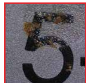
Lochkorrosionsbefall einer Pinzette. Ursache: Überalterung des Farbcodierungsbandes lässt Unterwanderung schädlicher, chloridhaltiger Substanzen zu.
