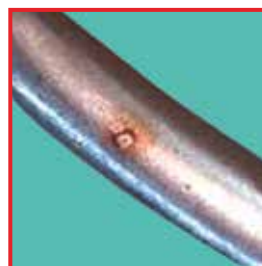
Lochkorrosionsbefall einer Pinzette. Ursache: Überalterung des Farbcodierungsbandes lässt Unterwanderung schädlicher, chloridhaltiger Substanzen zu.
