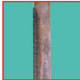
Knochenstanze, Gleitfläche des Schieberteiles zeigt Reibkorrosionserscheinungen
