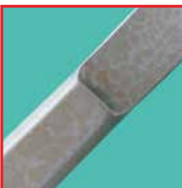
Typische Silikatverfärbungen treten, unabhängig von der Oberflächenbeschaffenheit , flächig, gelbbraun bis blauviolett im Reinigungs-Desinfektions-Prozess oder fleckenartig, tröpfchenförmig und mit ausgeprägtem kondensationsfleckenartigem Erscheinungsbild im Dampfsterilisationsprozess auf.
