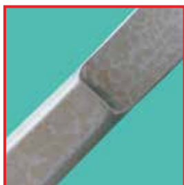
Fleckenmuster durch Verunreinigungen im Dampfkondensat
