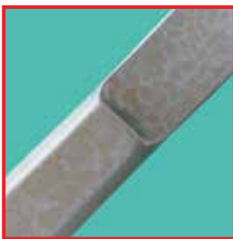
Fleckenmuster, verursacht durch Kieselsäure im Dampfkondensat.
