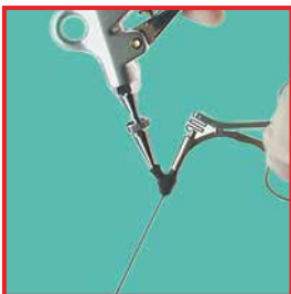
Durchspülen einer Fasszange mit Spülanschluss
