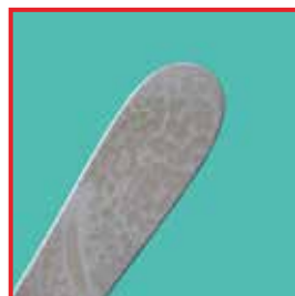
Typische Silikatverfärbungen treten, unabhängig von der Oberflächenbeschaffenheit , flächig, gelbbraun bis blauviolett im Reinigungs-Desinfektions-Prozess oder fleckenartig, tröpfchenförmig und mit ausgeprägtem kondensationsfleckenartigem Erscheinungsbild im Dampfsterilisationsprozess auf.
