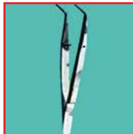
Partieller Beizangriff und Ablagerungen eines Ätzmittels zur Blutstillung auf der Instrumentenoberfläche. Ursache: zu lange Kontaktzeit
