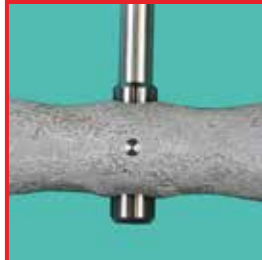
Materialangriff am Aluminiumgriff. Ursache: ungeeigneter alkalischer Reiniger
