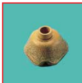
Alterungsrisse an einer Atemmaske
