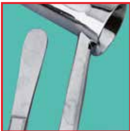
Verfleckungen auf Grund hohen Salzgehalts im Nachspülwasser
