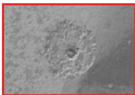
Rasterelektronenmikroskop-Aufnahme, chloridinduzierte Lochkorrosion
