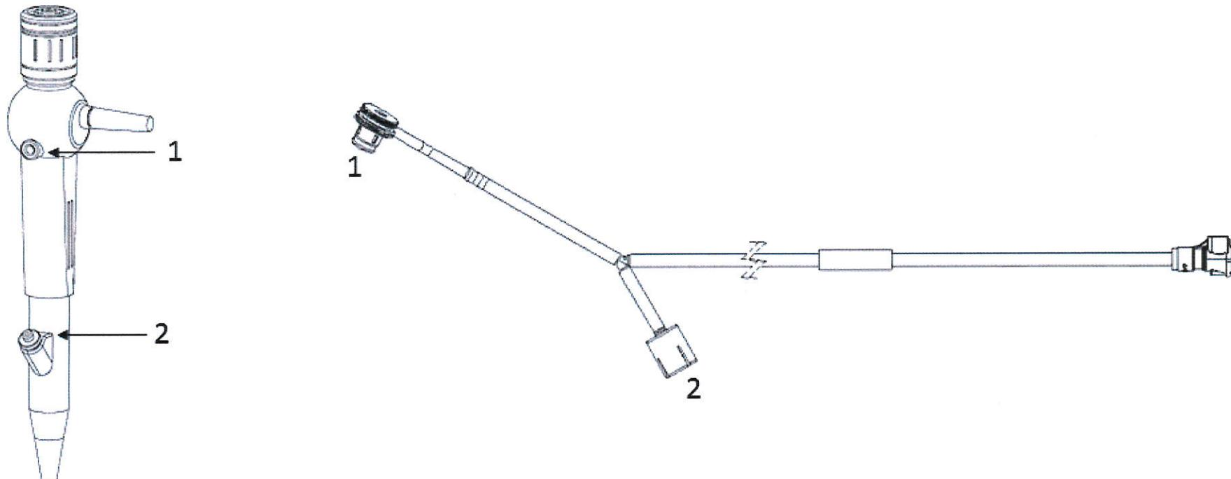
Beachten Sie bitte, dass alle Anschlüsse dicht und fest auf dem am Endoskop vorgesehenen Platz angeschlossen sind. Die Skizzen und die Nummerierung sollen bei der Orientierung helfen.
