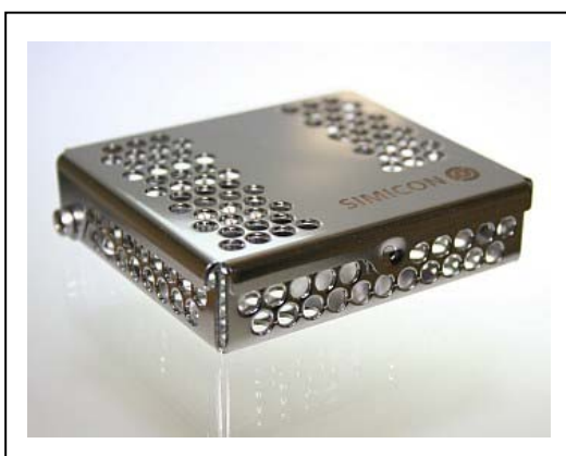
Abbildung 4 Halterung für Prüfkörper SIMICON RI (geschlossen)
