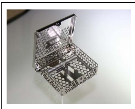
Abbildung 3 Halterung für Prüfkörper SIMICON RI (offen)
