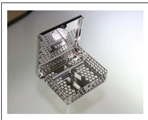
Abbildung 3 Halterung für Prüfkörper SIMICON RI (offen)
