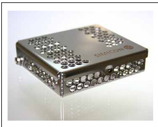
Abbildung 4 Halterung für Prüfkörper SIMICON RI (geschlossen)
