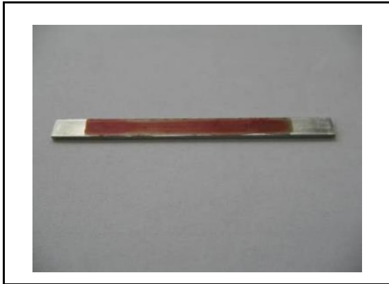
Abbildung 2 Metallplättchen mit Schafsblut-Anschmutzung
