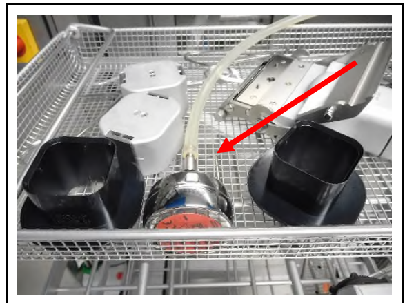
C2.2 Abbildung 12 Messpunkt Spüldruck
