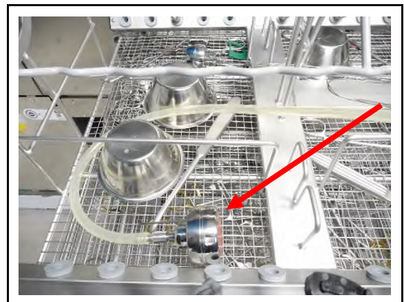
C1.2 Abbildung 12 Messpunkt Spüldruck
