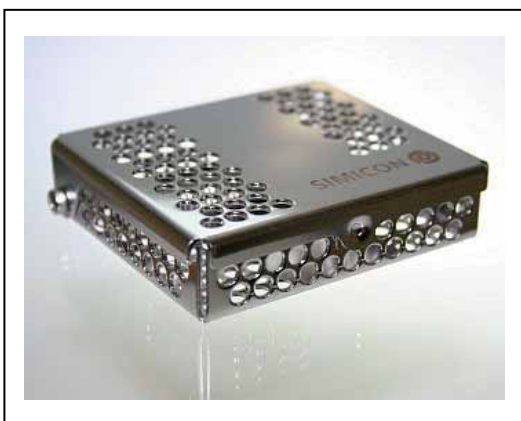
Abbildung 4 Halterung für Prüfkörper SIMICON RI (geschlossen)
