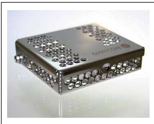
Abbildung 4 Halterung für Prüfkörper SIMICON RI (geschlossen)
