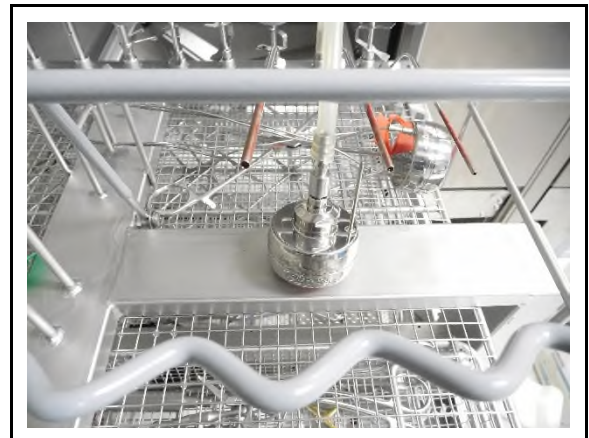
C1.2 Abbildung 12 Messpunkt Spüldruck
