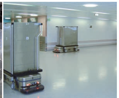
Abb. 9: AWT als fahrerloses Transportsystem
