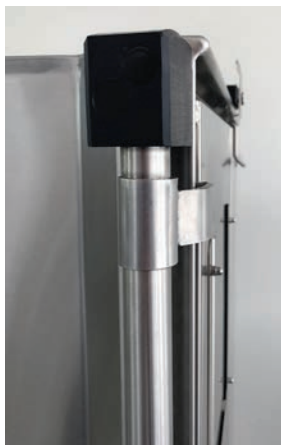
Abb. 14: Beispiel umlaufender Gehäuseüberstand
