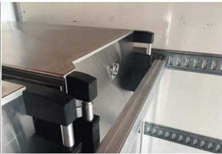
Abb. 12: Ladungssicherung, längs (Detail)
