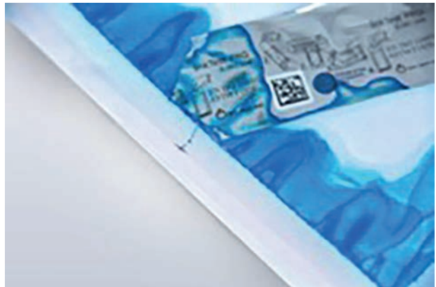
Abb. 6: Test nicht bestanden (Kanalbildung)
