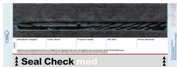
Abb. 4: Test nicht bestanden (z.B. falsche Temperatur)
