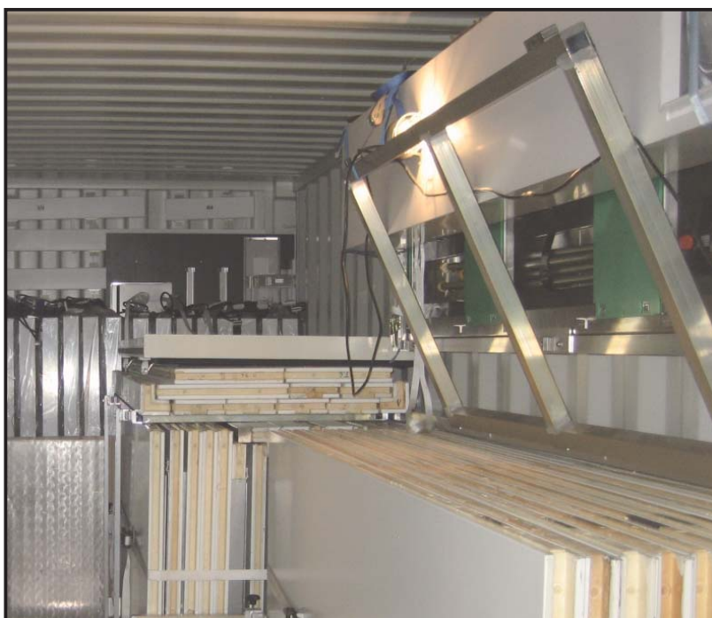
Abbildung 39 Klappen und Sichern des hinteren Rahmens
