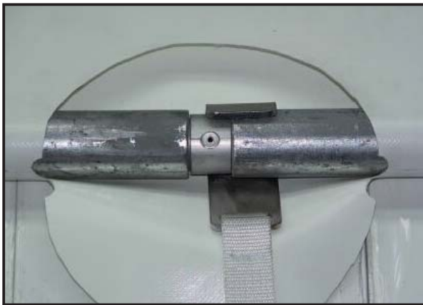
Abbildung 79 Spanngurt oben eingehakt
