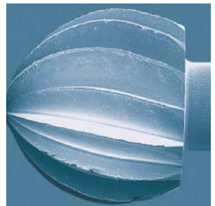
Mikroskopische Ansicht eines gereinigten, gebrauchten Fräasers mit Rückständen und mechanischen Verletzungen
