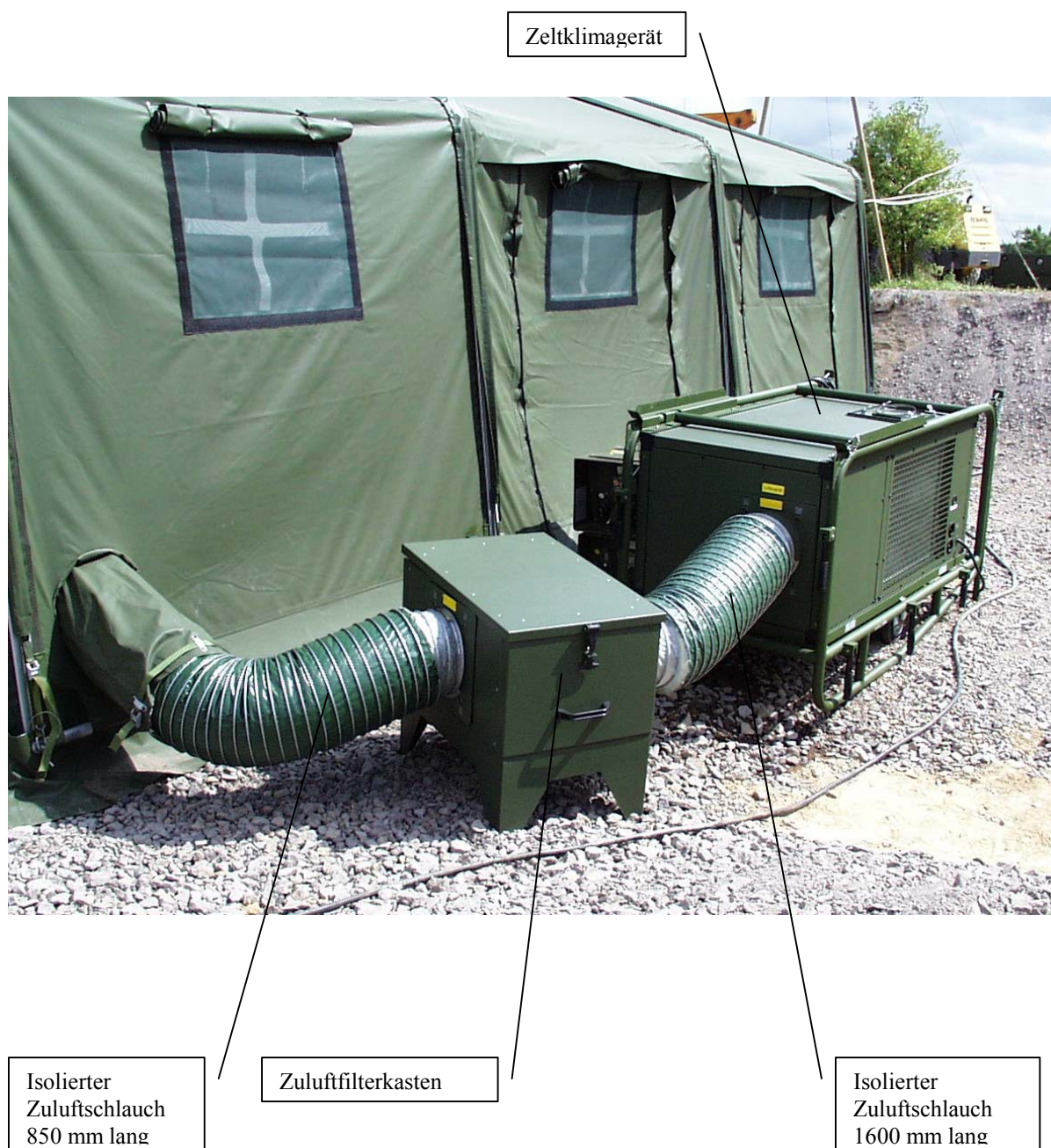
(Abb. 12) ZKB 15 mit isolierten Zuluftschläuchen und Zuluftfilterkasten im Einsatz
