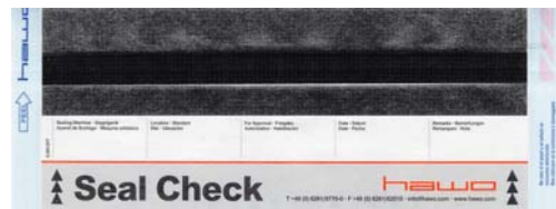
1. Intakte Siegelnaht über die gesamte (festgelegte) Breite gemäß DIN EN ISO 11607, Teil 2
