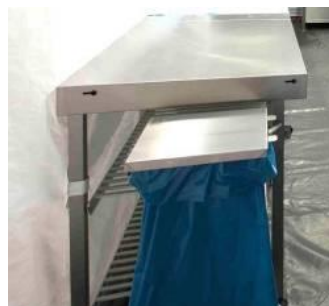
Abb. 10: Schwenkbarer Abwurfbehälter, mobile Abfalltrennbox
