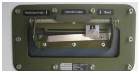
Abb. 22: Einstellbare Luftklappen zur Steuerung der Luftströmung
