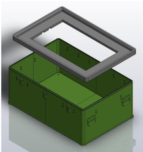
Legen Sie zuerst den Schaumstoff T2A (Art.-Nr. 602402-T2A) auf den Boden des Unterteils B40 Y.
