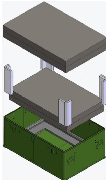
Legen Sie auf den Schaumstoff T2A zwei Edelstahltische MSE (Art.-Nr. 600139) im Transportzustand gegengleich aufeinander, so dass die Zapfen einrasten. Stecken Sie in jede Kistenecke einen Schaumstoff T2B (Art.-Nr. 602406-T2B). Legen Sie zwei weitere Edelstahltische MSE gegengleich aufeinander in die Kiste.
