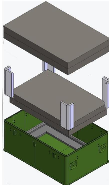
Legen Sie auf den Schaumstoff T3A zwei Edelstahltische MSE (Art.-Nr. 600139) im Transportzustand gegengleich aufeinander, so dass die Zapfen einrasten. Stecken Sie in jede Kistenecke einen Schaumstoff T3B (Art.-Nr. 602406-T3B). Legen Sie zwei weitere Edelstahltische MSE gegengleich aufeinander in die Kiste.
