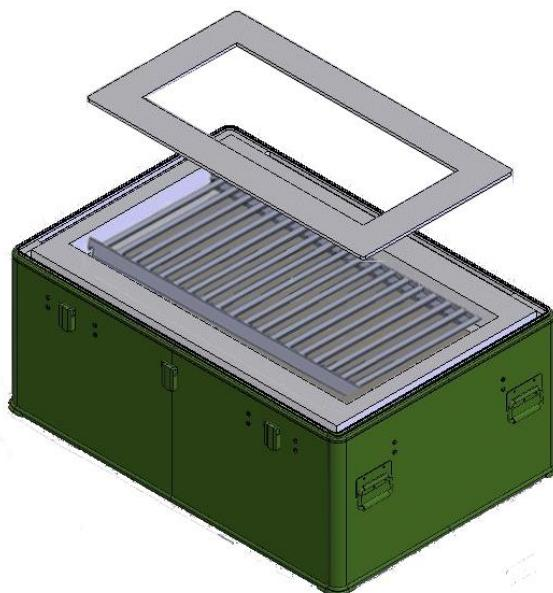
Legen Sie die beiden Rostauflagen (Art.-Nr. 600143) in die Aussparung des Schaumstoffs T3C. Platzieren Sie den Schaumstoff T3D (Art.-Nr. 602407-T3D) über den Rostauflagen.
