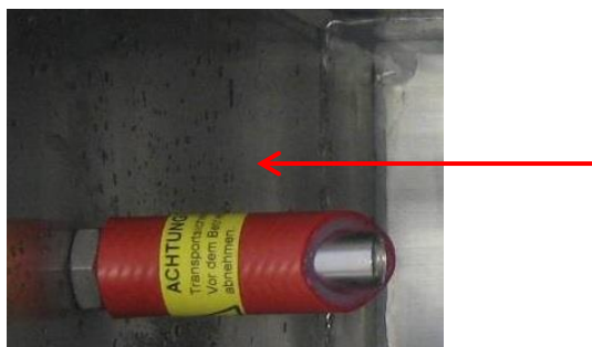
Abb. 15: Anbringen der Transportsicherung Schwimmerschalter
