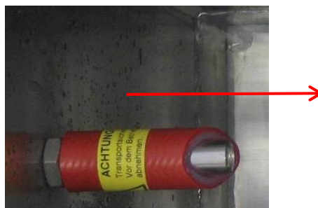
Abb. 4: Entfernen Transportsicherung Schwimmerschalter
