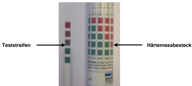
Abb. 5: Teststreifen und Härtemessbesteck
