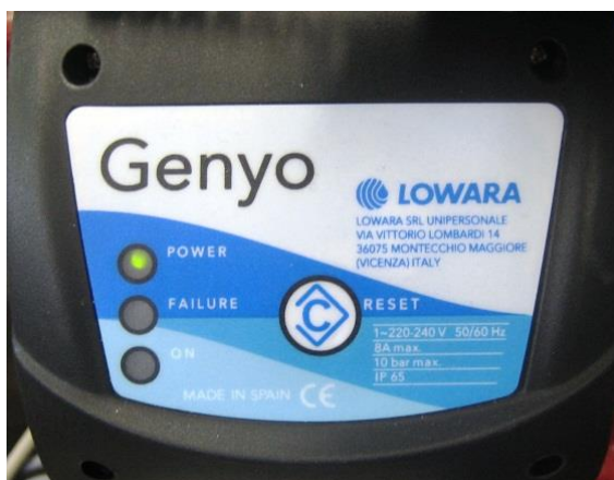
Abb. 5: elektronische Pumpensteuerung der Permeatpumpe
