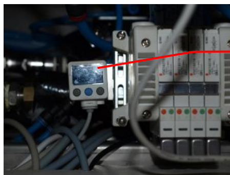
Abb. 11: Differenzdruckmesser SMC Rückseite VARIOKLAV® ECO 300 HC
