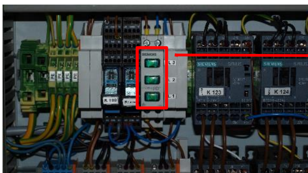
Abb. 28: Phasenkontrollleuchten Rückseite Schaltschrank VARIOKLAV® ECO 300 HC
