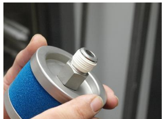
Abb. 24: Eingedichteter Sterilfilter LF1
