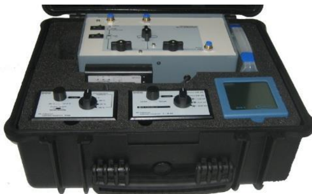
Abb. 6: Prüfgerätausstattung Wartung Sterilisator
