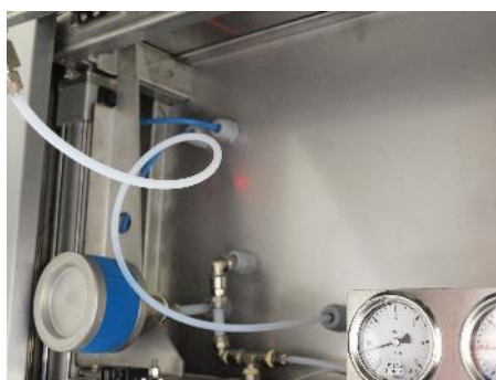
Abb. 23: Sterilfilter LF1 bei geöffneter Bedienerfront
