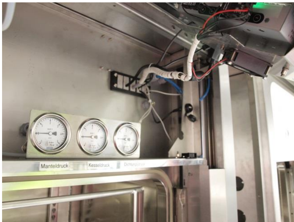
Abb. 2: VARIOKLAV® ECO 300 HC Frontansicht mit geöffneter Frontklappe und Manometer der Dampferzeuger DR9, DR18 und der Türdichtung
