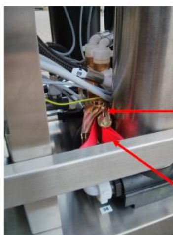
Abb. 4: Rückansicht Waschtisch mit RO-Modulblock k
