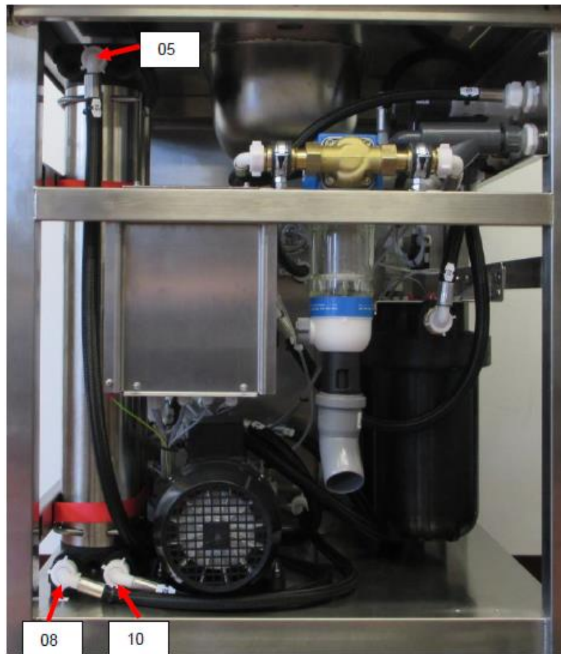
Abb. 1: Waschtisch mit UOA – Schlauchleitungen zum Entleeren Osmose-Module
