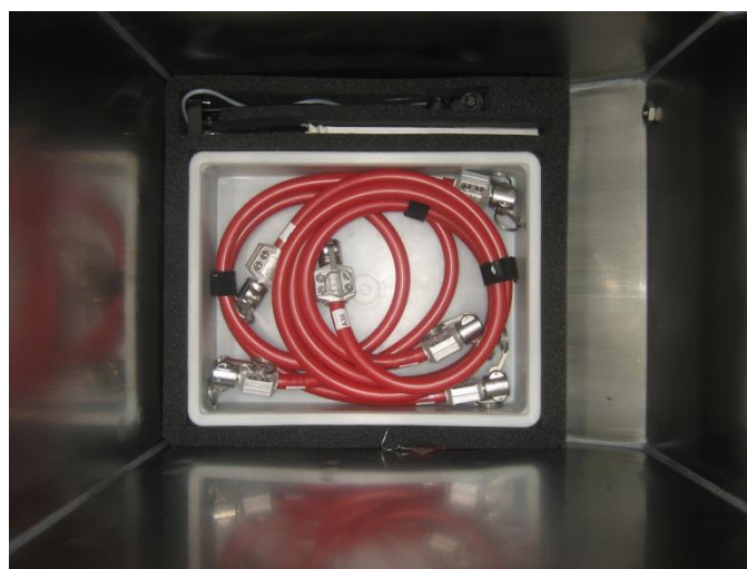
Abb. 5: Einsetzen des gepackten Schaumstoffes TG in den Permeattank
