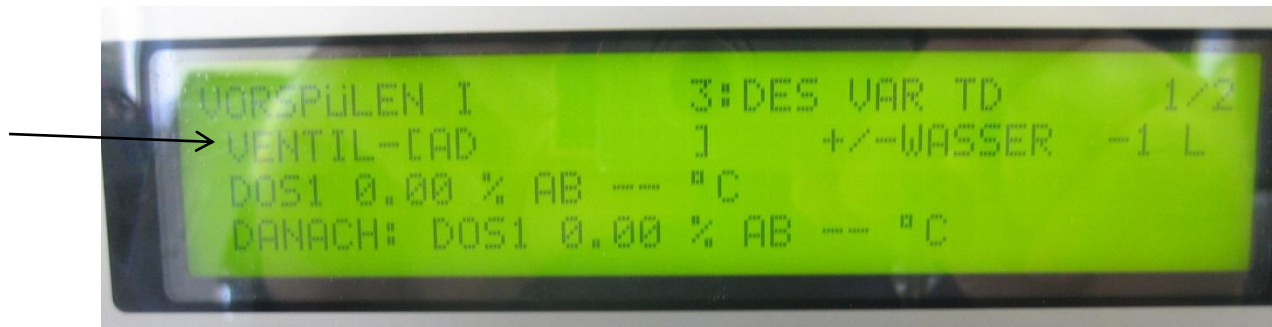
Abb. 9: Beispiel Vorspülen I mit VE-Wasser: VENTIL- AD
