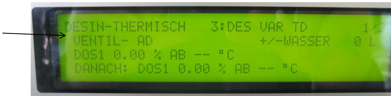
Abb. 7: Programm DESIN-THERMISCH immer mit VE-Wasser: VENTIL- AD
