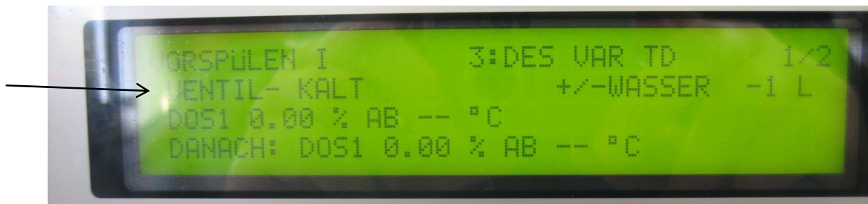
Abb. 10: Beispiel Vorspülen I mit Permeat: VENTIL- KALT
