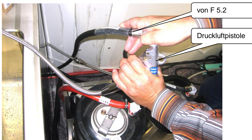
Abb. 1: Ausblasen der VE-Wasserleitung mit Druckluft
