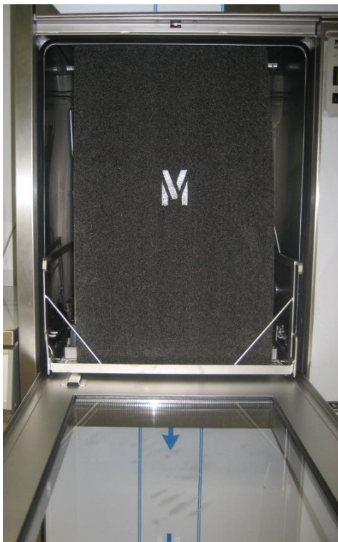
Abb. 7: Schaumstoffzuschnitt M, Korb E 715, unreine Seite
