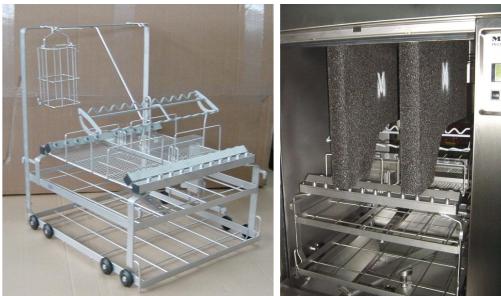
Abb. 5: Fixieren des Injektorwagens E 705 mit zwei Schaumstoffzuschnitten M
