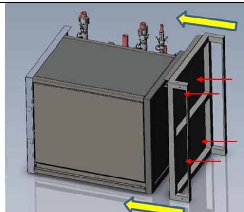
Nehmen Sie den Gerätesockel von der Abwasserhebeanlage ab.
