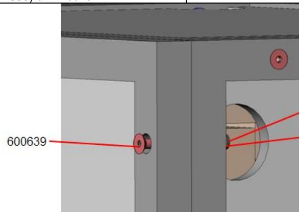
Befestigen Sie die beiden Seitenteile (Art.-Nr. 605729) mit jeweils 2 Senkschrauben M10x100, Scheibe D30 und Sechskantmuttern M10 (Art.-Nr. 600639, 600642, 602693) am Deckel.
