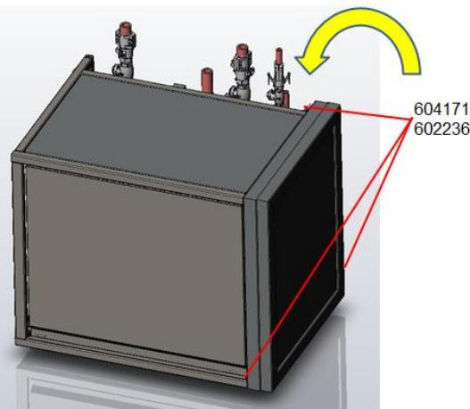
Nehmen Sie die Abdeckung Schrank Hebeanlage (Art.-Nr. 604718) ab.
