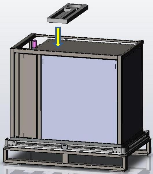
Legen Sie den Schaumstoff S6E (Art.-Nr. 606482-S6E) mit der UV-Lampe UV5.1 so auf den Deckel des Permeattanks, dass er zwischen 2 Rippen der Arbeitsplatte zum Liegen kommt
