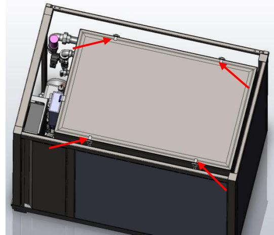
Befestigen Sie den Deckel des Permeattanks mit den Klappbügeln (rote Pfeile)
