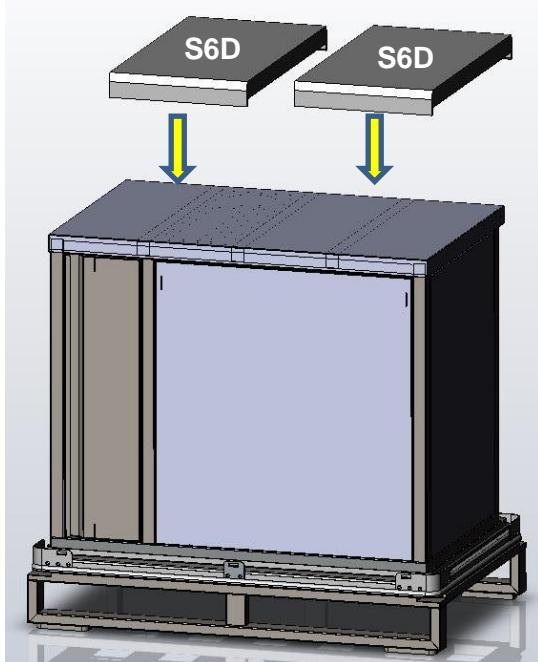
Montieren Sie die Arbeitsplatte und legen Sie die beiden Schaumstoffe S6D (Art.-Nr. 605964-S6D) auf den Permeattank
