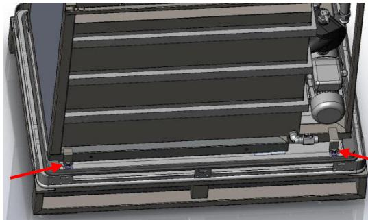
Verriegeln Sie den unteren Tankrahmen mit zwei Flügelmuttern (rote Pfeile) am Boden Haubenbehälter
