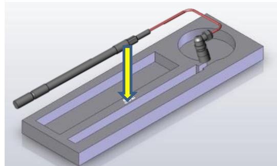
Legen Sie die UV-Lampe UV5.1 (Art.-Nr. 602957) in den Schaumstoff UV-Lampe Permeattank EL S6E (Art.-Nr. 606482-S6E)
