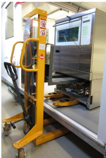
Abb. 5: Anheben des RDG-E Belimed WD 430 mit dem Hydraulikstapler
