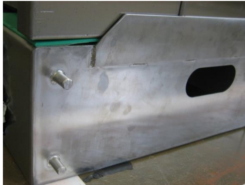
Abb. 5: Zwei Zapfen zur Fixierung des Versorgungssockels am Rahmenrohr
