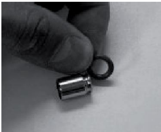
Abb. 9: Montieren der O-Ringe
