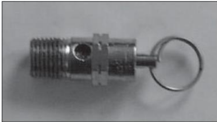
Abb. 6: Ring am Sicherheitsventil
