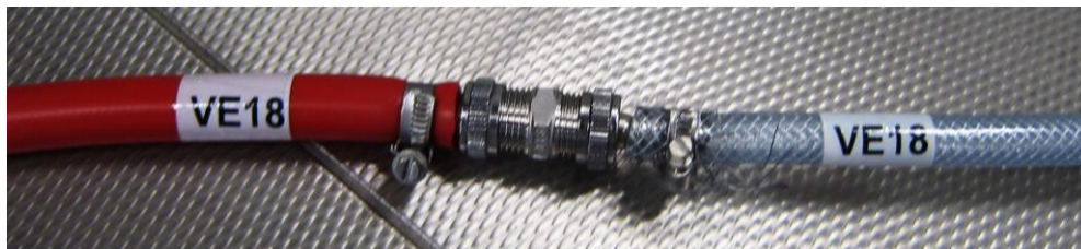
Abb. 8: Koppelung der Schläuche mit Doppelnippel Edelstahl R3/4
