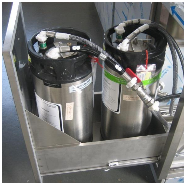
Abb. 4: Auszug mit Ionenaustauscherpatronen
