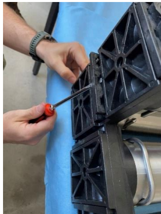
Abb. 3: Fixierkamm zwischen oberen und darunterliegenden Modulrohr
