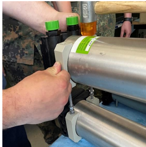
Abb. 7: Obere und untere Modulrohr mit Gewindestange befestigen
