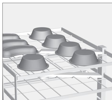
■ Gefäße, z.B. Dosen, Becher, Nierenschalen, mit der Öffnung nach unten so im Wagen einordnen (möglichst in oberer Ebene), dass sie die Reinigung der Instrumente nicht behindern und durch die Spülmechanik nicht umgedreht werden.
