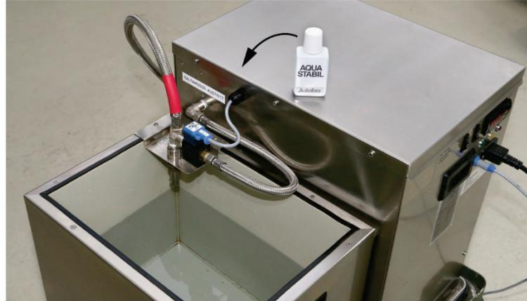
Bild 21: Aquastabil für das Kühlwasser
